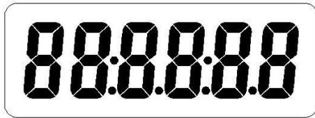
6 stellige Zählwertanzeige für +A (Energiebezug). Die Einheit kWh ist rechts neben der Anzeige auf dem Gehäuse dargestellt
